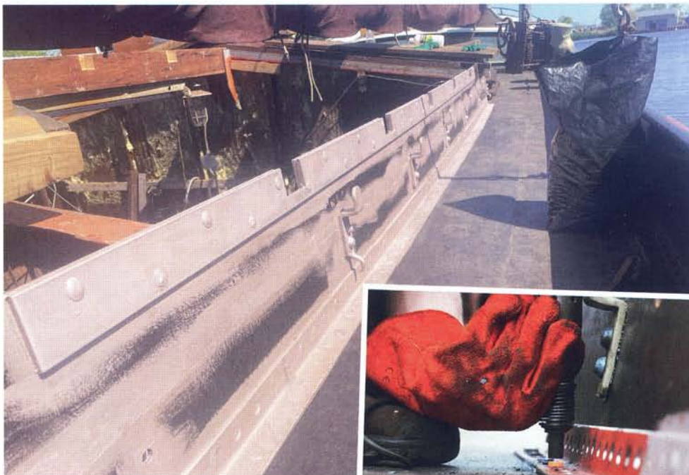
rechts: De den was aan het gangboord gelast. Riemer klom er met zijn broer voor het originele beeld toch weer een hoeklijn tegenaan
