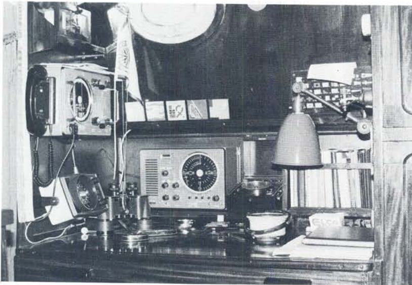
S.B.-vóór in de kajuit is de kaartentafel. Barograaf, marifoon, dieptemeter, ontvanger en chronometer vormen het 'instrumentarium'.
