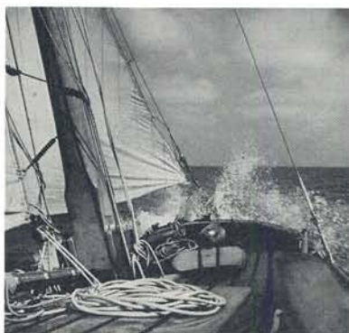
Afb. 21 Voordek boeier 'Constanter'. Let op de keurige wijze waarop de vallen zijn 'geklaard'. De meestal ongestaagde mast, is hier gestaagd in verband met de zeegang voor Den Helder. Zomer-reünie Stichting Stamboek Ronde- en Platbodemjachten, 1959. Foto: J. de Vries
