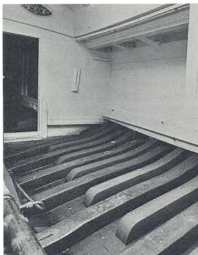
Afb. 16 Leggers en inhouten met tevens een doorkijkje vanuit de roef in het vooronder van de boeier 'Constanter'. Foto: Paul Janssen
