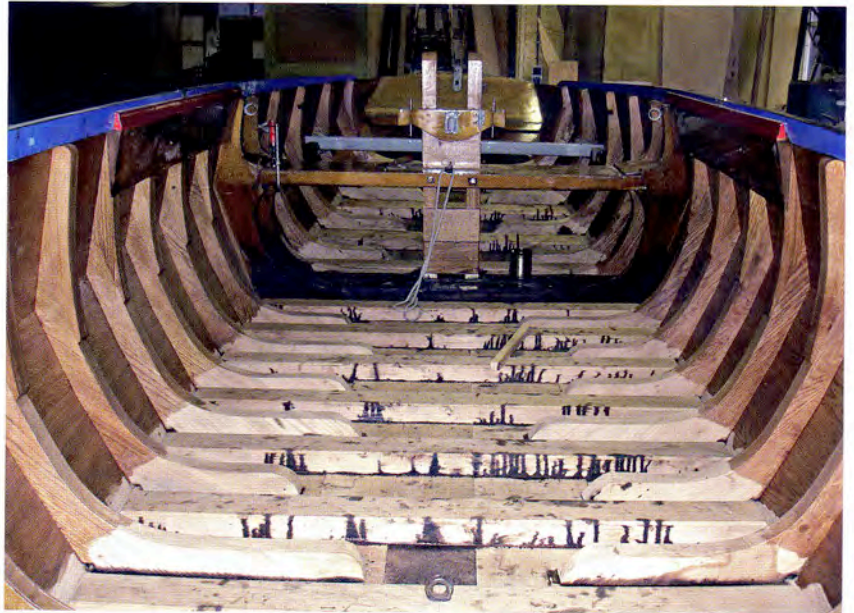
Fig. 14 Een mooie rij leggers, gelijkmatig over het rechte vlak verspreid.
