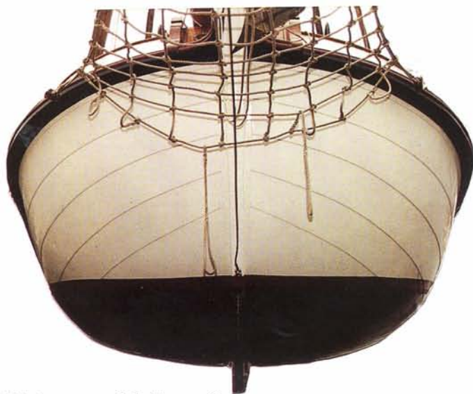
VA 1 Schollevaer II Ontwerp H. Kersken Bouw De Vries, Aalsmeer, 1938 Eigenaar Stg. Schollevaer Afmeting 13,93 x 4,50 m Gewicht 20 ton, 23,1 ton na weging Vol en zwaar, dat was in die tijd nog usance. Het geklonken jacht is onlangs geheel gerestaureerd. De relatief weinig huidgangen verlopen elegant.
