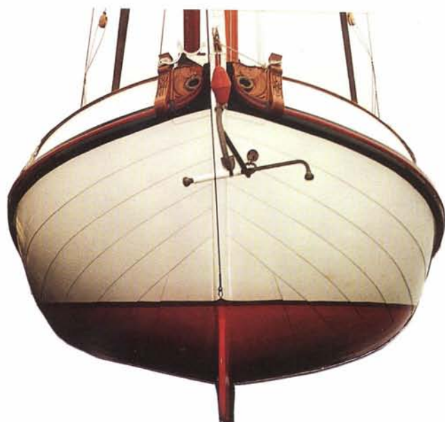
VA 139 De Zwijger Ontwerp André Hoek Bouw Dick Kloos (casco), Cor Klijn (afbouw), 1992 Eigenaar W. de Boer Afmeting 13,00 x 4,20 m Gewicht 18,5 ton, 19 ton na weging Twee brede vlakplaten en een weglopende vlakgang. Een vrij volle, elliptische kim met daarboven enigszins V-vormig verlopende huidgangen.
