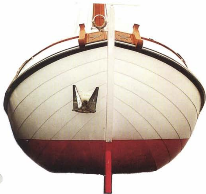
VA 143 Zeemeermin Ontwerp Blom Bouw Blom, Hindeloopen, 1994/95 Eigenaar R.W. van Werkhoven Afmeting 12,80 x 4,30 m Gewicht 19 ton, 20,7 ton na weging Twee zware vlakplaten en een cirkelvormig verlopende kim, vijf huidgangen die steeds vlakker verlopen.
