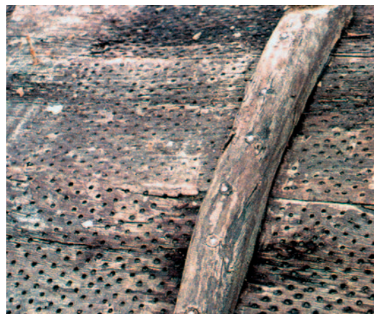
Fig. 28 en 29, rechts De wijze van afdichten van de naden tussen de planken van de bundeken. (bij rode stip zijn sintels)
