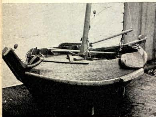
2. Model van de Vollenhovense schuit of schokker. Het donkere rechthoekige vlakje boven het berghout tegen de steven is het z.g.n. krophout.
