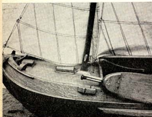
3. Voorschip van een botter. Let op de vorm van de steven en het verloop van de boeïsel in vergelijking met de schuit van foto 2 en de bol van foto 5.
