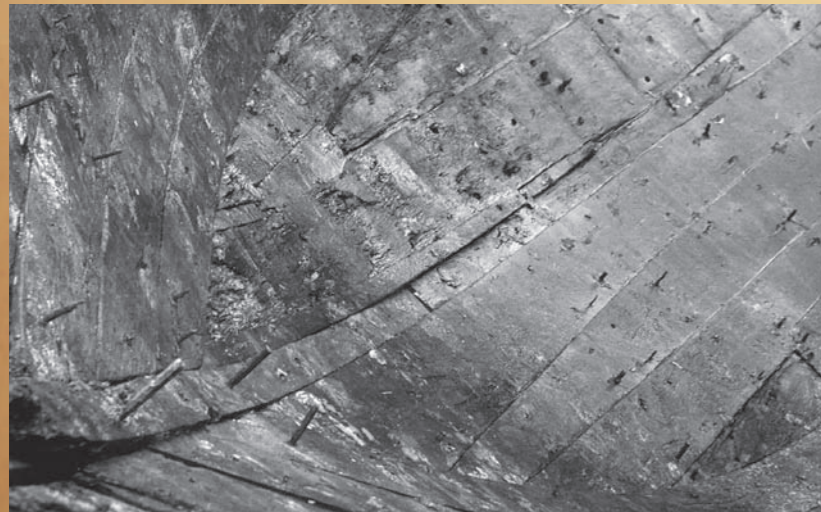
Fig. 9 De zichtbare kiel met de voorsteven. In het midden is de overgang zichtbaar van knoop naar steven.
