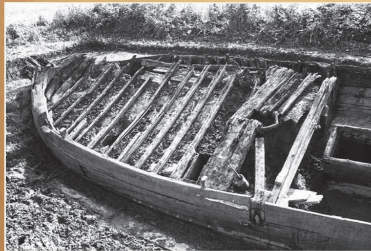
Fig. 33 De zwaar beschadigde mastbalk met daarvoor de waterbalk. Deze is met een horizontale knie op de zware zwaardknie bevestigd. Daar is ook de zwaardbevestiging te zien.
