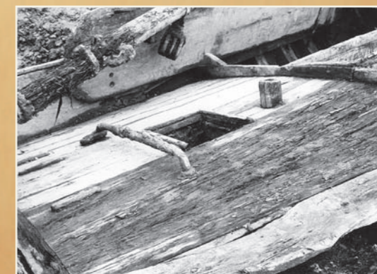
Fig. 31 Het achterdek vrijgemaakt van de modder waar de giek en het zwaard nog overheen liggen.
