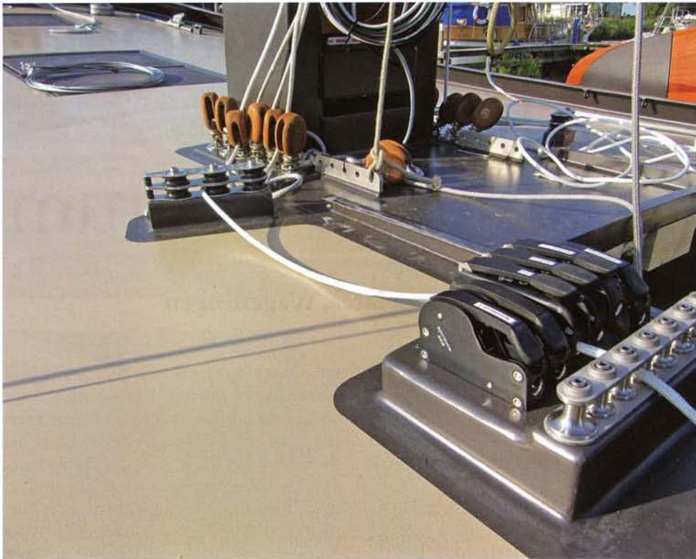
Het aanbrengen van de vallen en lijnen bij de mast
