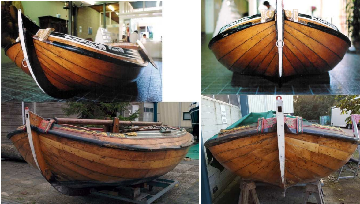
Jannetje versus Aeolus. Let op de gelijkenis van het stevenprofiel en het stevenbeslag. De manier waarop het berghout is geconstueerd en vormgegeven is identiek. Bij het Fries jacht Murkjen (Lantinga 1902) kom je een soortgelijke constructie tegen, maar de uitvoering is zwaarder). De scheepjes zijn qua constructie gebouwd als tjotter. Het berghout vult de hoek tussen boeisel en berghoutgang op.
