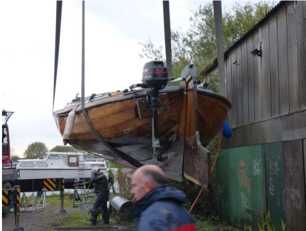
Foto GtC. 2 november 2012 Aeolus tijdens het takelen in Krimpen aan de Lek. Het roer heeft dezelfde kleur als de romp. Het is echter gemaakt van grenenhout. De weegklok op de kraan gaf 900 kilo aan voor de romp met vlonders, roer, botteloef, giek, buitenboordmotor en dekkleed. Op 3 november 2012 heeft de Aeolus onderweg van Krimpen aan de Lek naar Zuidlaren op de beurs Klassieke Schepen in Enkhuizen gestaan.
