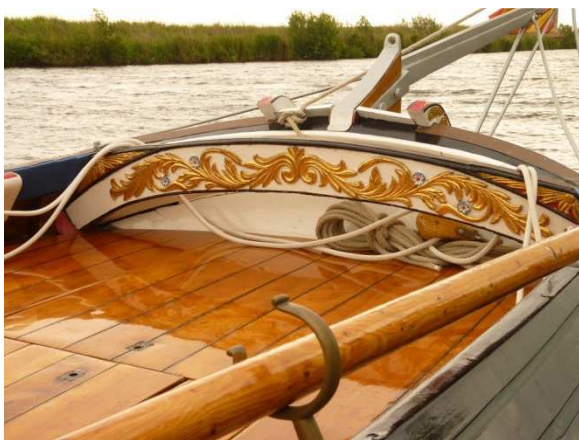
Bedelbalk van het in 1895 gebouwde Friese jacht Argo (foto GtC)
