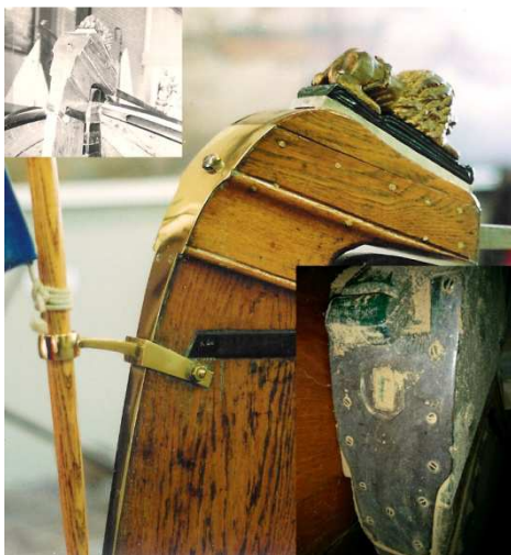
Roer en achterschip Jannetje. Inzet roerkop met origineel roerbeslag Aeolus.
