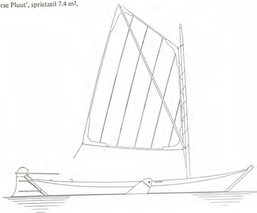
Zeiltekening van de Giethoornse punter 'Orse Pluut', sprietzeil 7.4 m 2 ,
