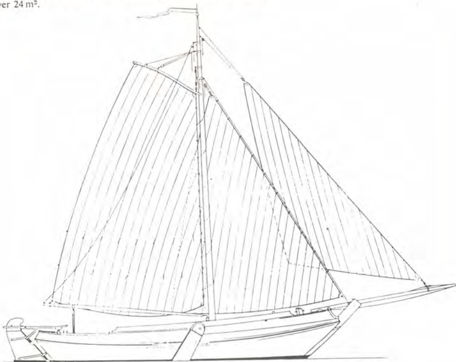
Zeiltekening van de schokker 'UK 110', grootzeil 58 m², fok 39 m², kluiver 24 m².
