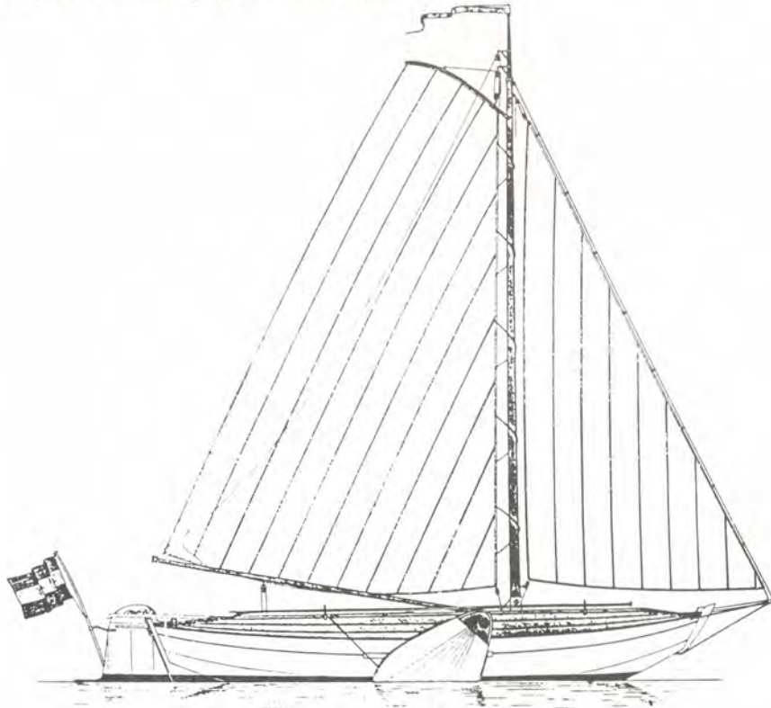
Zeiltekening van de schouw 'Jaega', grootzeil 16 m², fok 8 m²
