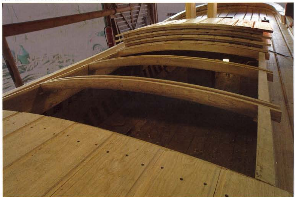
Onder: De luiken liggen los op wegneembare houten goten (merkels). De gasten kunnen dan, tijdens het zeilen, vrij in het ruim rondlopen.
