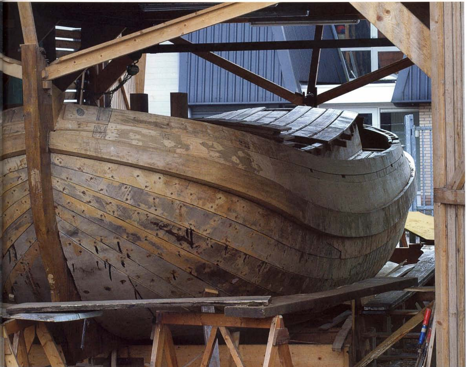
Ook de boeïseln zijn aangebracht, nu worden de lijnen goed zichtbaar.
