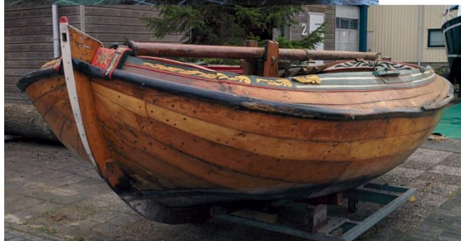
'Jannetje' versus 'Aeolus'. Let op de gelijkenis van het stevenprofiel en het stevenbeslag.
