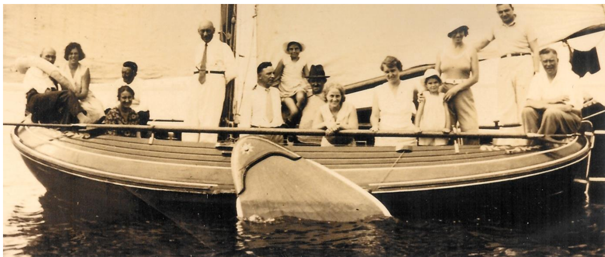
Roer en achterschip 'Jannetje'. Inzet roerkop met origineel roerbeslag 'Aeolus'.
