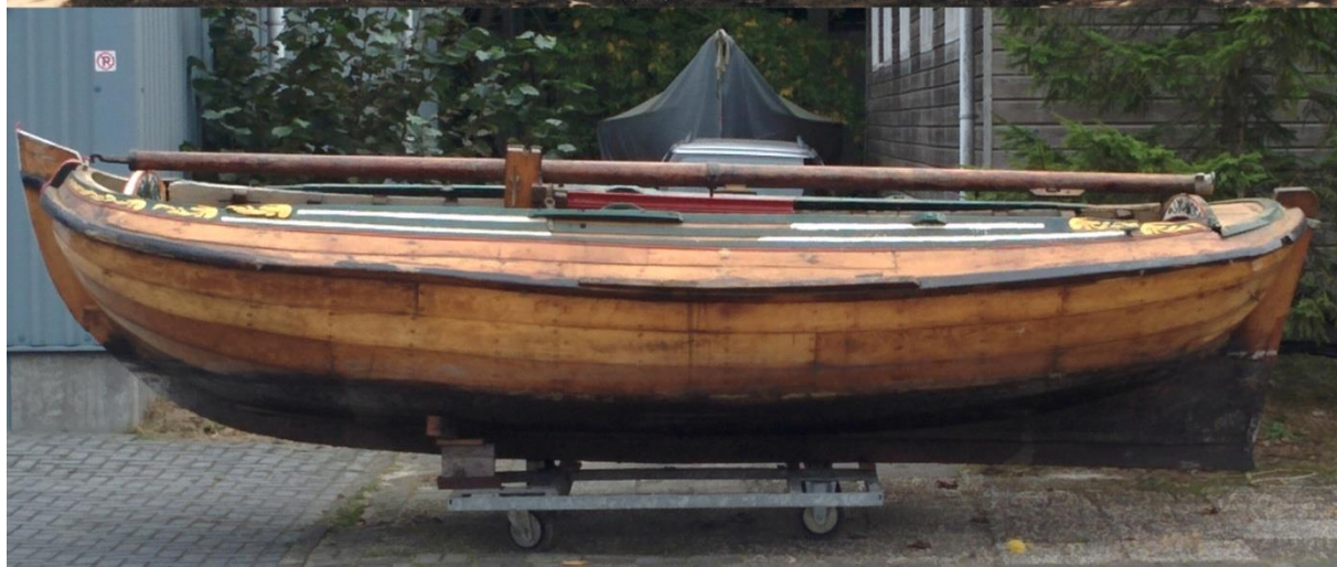
'Frisia' boven 'Aeolus' onder. Let op gelijkenis oa. schildpadblok op boeisel en kantellat boven de zwaardbout.
