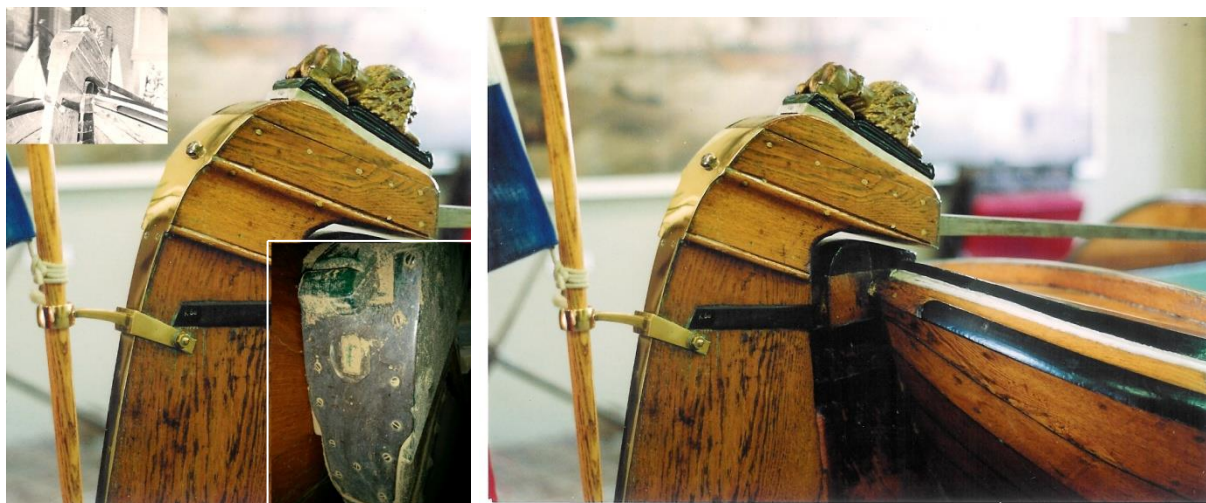
Roer en achterschip 'Jannetje'. Inzet roerkop met origineel roerbeslag 'Aeolus'.
