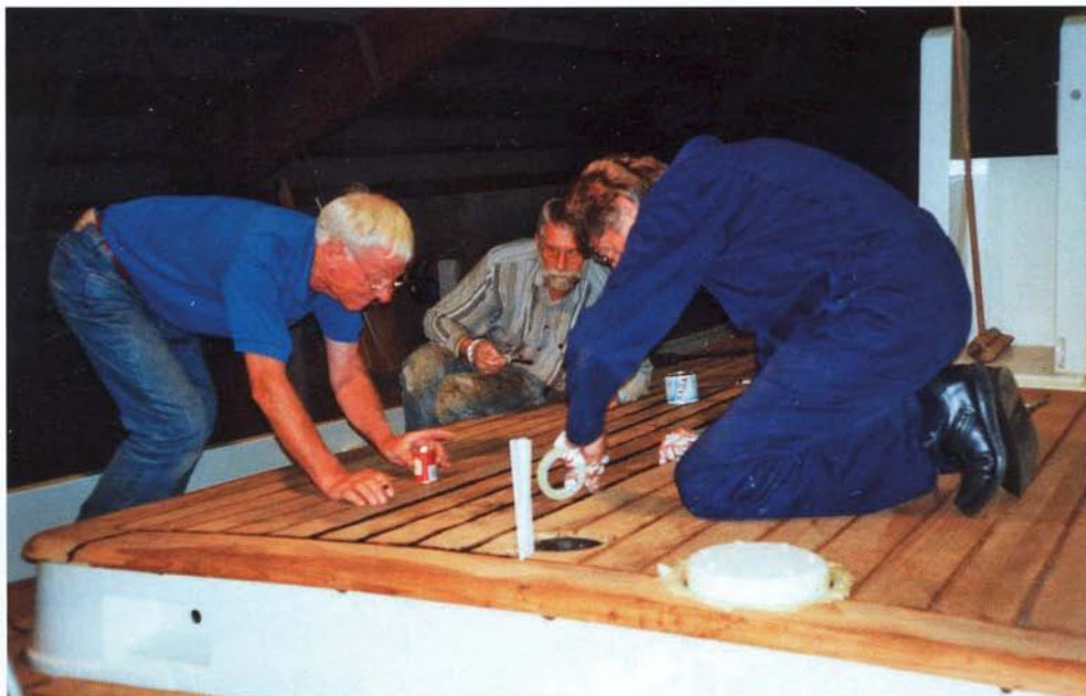
Het tapen en in de primer zetten van het dek. Harry (l) en Fredrik.
