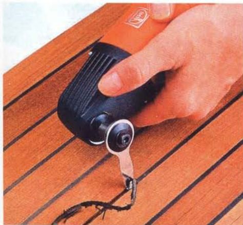
Verwijderen van rubbernaden met een multimaster.
