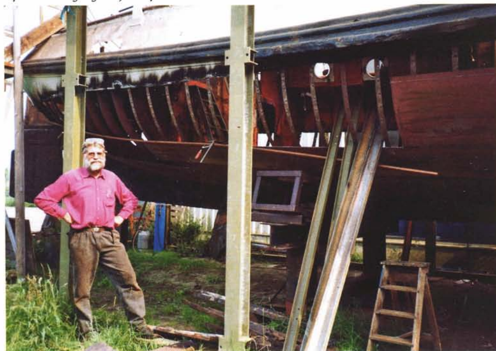
Op de nieuwe gangen zijn de sporen van het walsen te zien.
