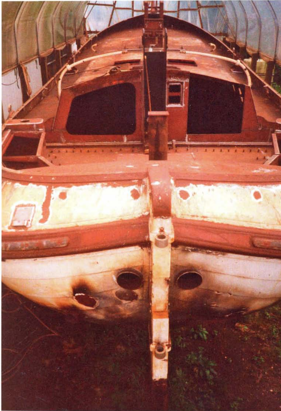
Boven: Klaar voor de straler. Onder: In de GP grondlaag.
