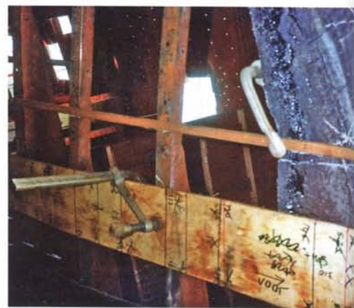
Plank en lat voor het opmeten van de gangen.
