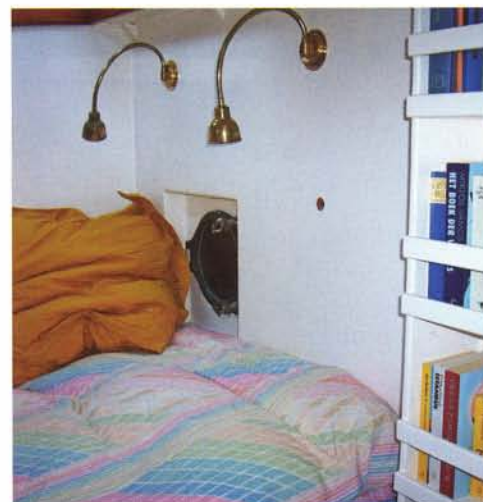
Slaapkamer met patrijspoort voor inspectie van de hijskabel van het zwaard.
