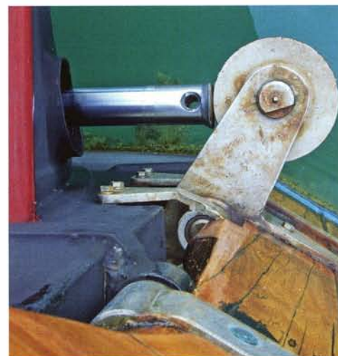
Overbrenging druk van stuurmachine op roer.
