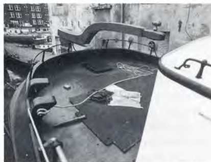
Achterdek waarbij opvalt dat er veel aandacht is besteed aan details, met veel mooi siera-smeedwerk en de uit een dukdalf gemaakt helmhout.
