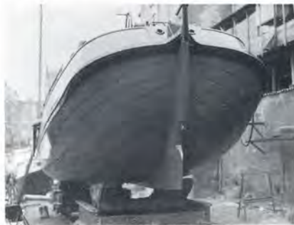
Duidelijk zichtbaar is de in breedte verlopende stevenbalk.
