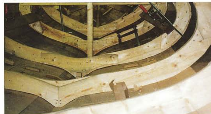
April 1996. De eerste gangen, let op de gepiekte spantvorm.
