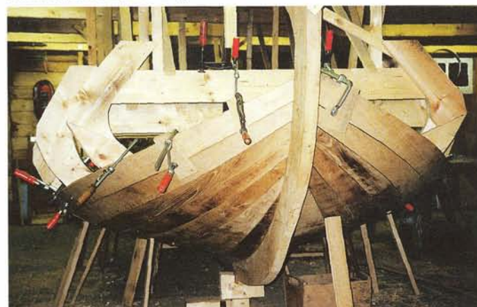
De gangen komen al boven de waterlijn.
