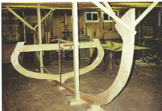
Het eerste hulpspannt staat opgesteld op de kielbalk, de stevens zijn definitief.
