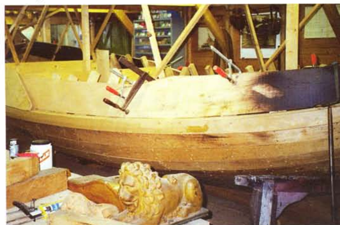
Het boeisel wordt aangebracht. Let op leeuw en roer in wording.
