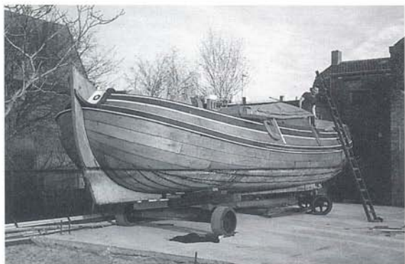
"Bever" van David Proctor, jachtwerf Verras te Walsjoorden; de opbouw van de huid is duidelijk zichtbaar. Foto: D. Proctor
