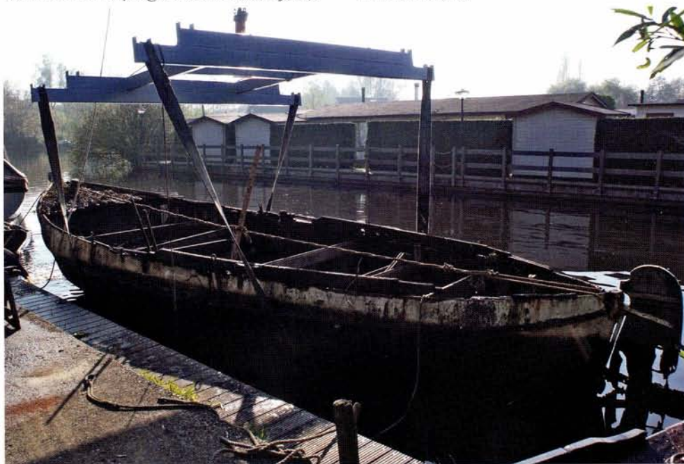
Een tros van voor- naar achtersteven moet zorgen voor langsverband. Onder: Dankzij aangebrachte dwarsverstevigingen kan de steekhengst uit het water worden gehesen door Peter Schouten.
