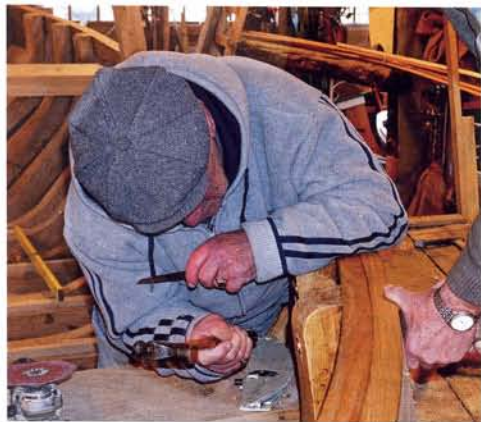
De spanten zijn met koperen nagels aan de huid geklonken. Een vrijwilliger werkt de geklonken kop nog wat af.
