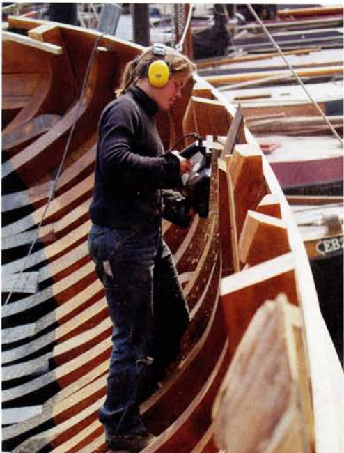
De romp is bijna klaar, nu de potdeksels, dekbalken, dek en opbouw nog.
