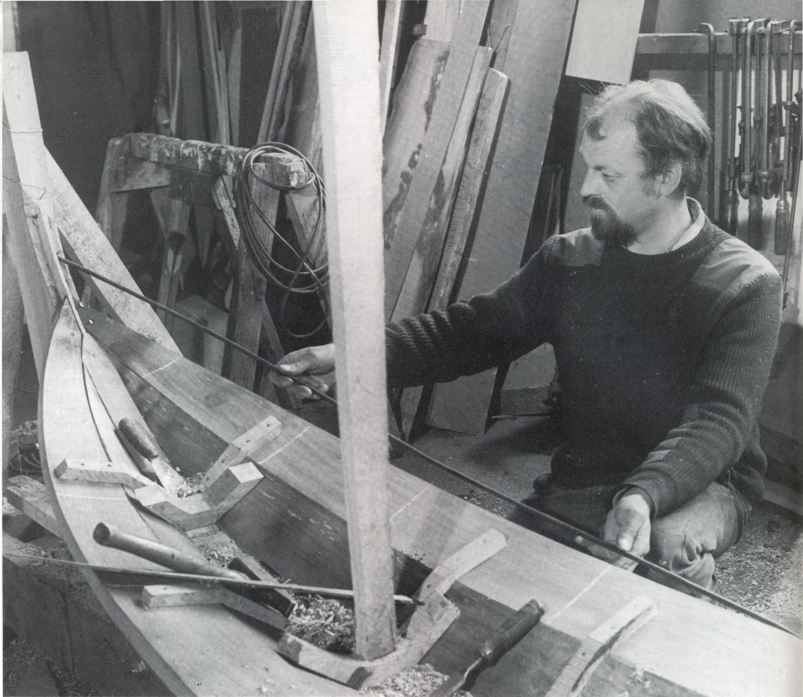
Pier Piersma buigt zijn stalen mal op maat voor de volgende gang. Deze sloopjes worden nog steeds grotendeels op het oog ge- bouwd.
