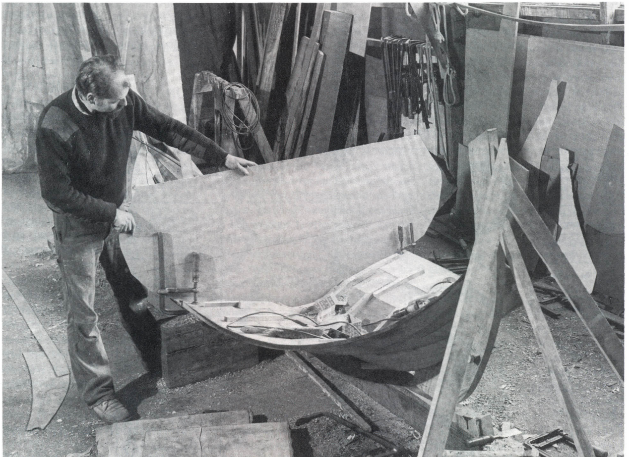
De eerste gangen van het boeierke zijn aangebracht.
