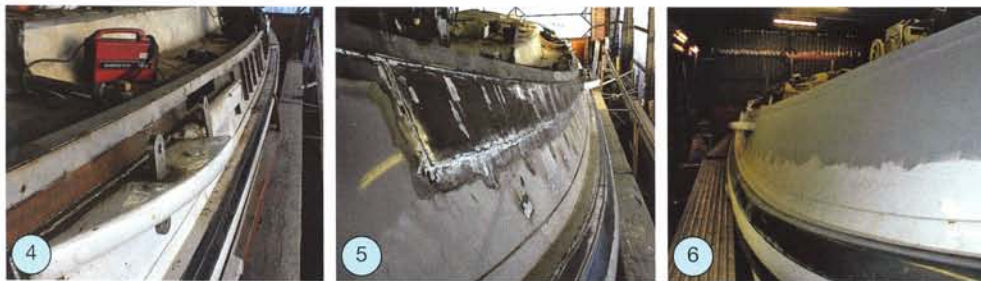
4. Nieuwe wantputtingen. 5. De steunen zijn verwijderd. 6. De eerste lagen plamuur zijn aangebracht.
