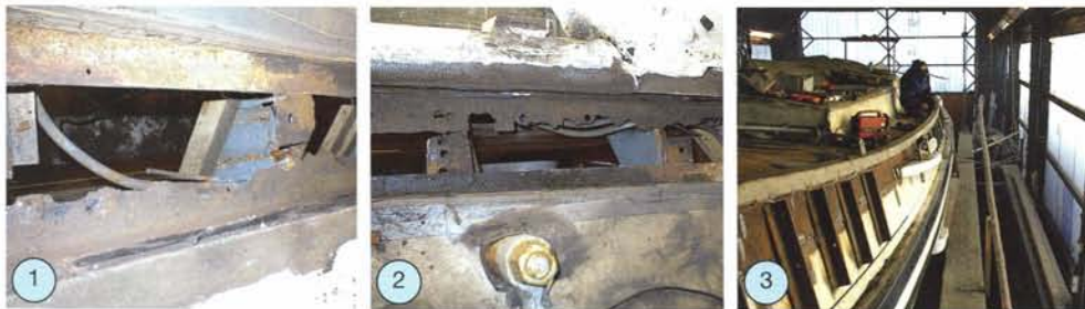
1 en 2. Er bleef niet veel over van het boeisel. 3 Het nieuwe boeisel is vastgelast, de steunen kunnen weer worden verwijderd.
