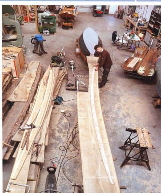
November 2008 - De mal voor de vijf meter lange gang ligt op de eiken stam. In het midden van de plank is het hart van deze honderdjarige eik te zien, het stammetje uit zijn jonge jaren. Dit deel van de plank is niet bruikbaar omdat er te veel scheuren en noesten in zitten.
