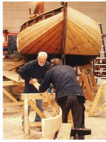
November 2008 - Met klemmen zit een mal van multiplex op het schip geklemd om daarmee de juiste maat van het eikenhout te kunnen bepalen.
