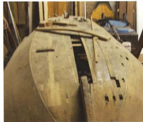
De zwart geworden gedeelten met ijzeren spijkers zijn uitgezaagd zodat er nieuwe stukjes ingelijmd kunnen worden.
