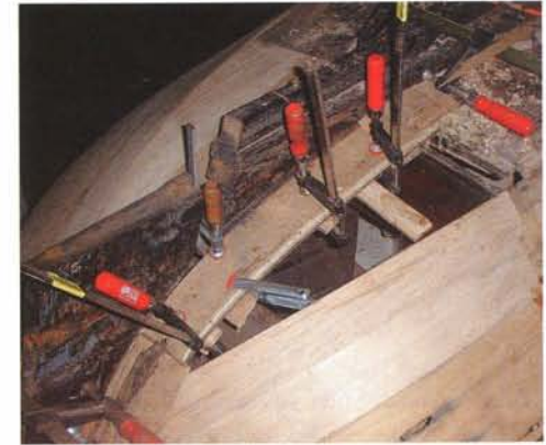
Hoewel begonnen werd met het achterschip, bleek achteraf dat er veel rot hout zat tussen de spanten en de vlakdelen. Toen werd toch maar het hele vlak vervangen.
