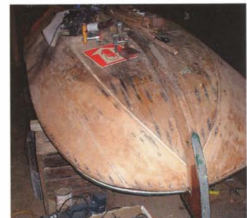
Hoewel begonnen werd met het achterschip, bleek achteraf dat er veel rot hout zat tussen de spanten en de vlakdelen. Toen werd toch maar het hele vlak vervangen.
