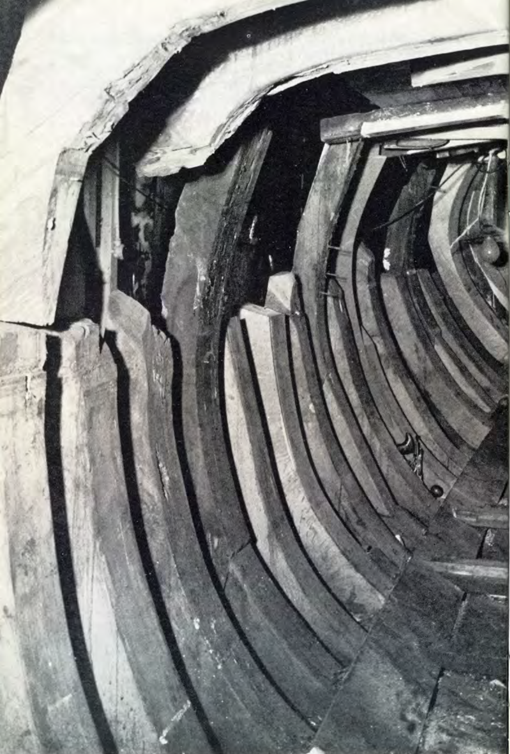
De „ribbenkast' (inhouten) van de „Friso", gefotografeerd toen het schip voor een grote beurt op de helling lag.
