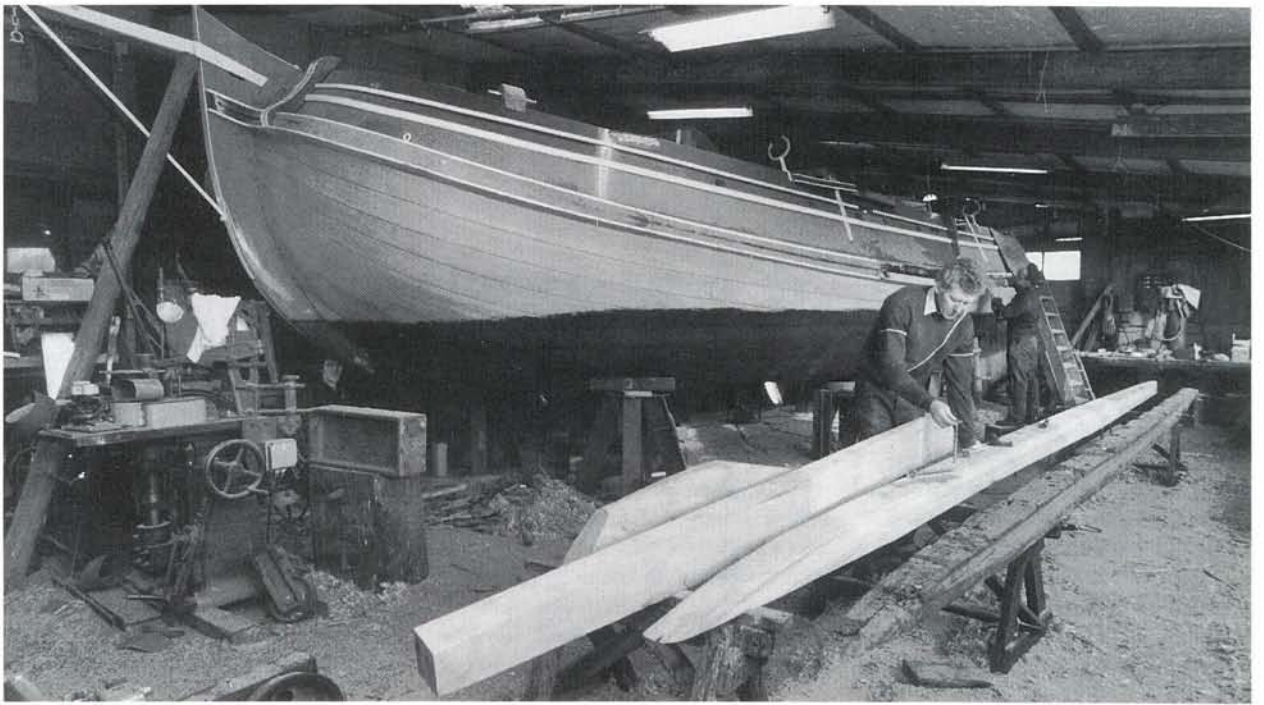
De nieuwe kielbalk ligt klaar om te worden geplaatst.
