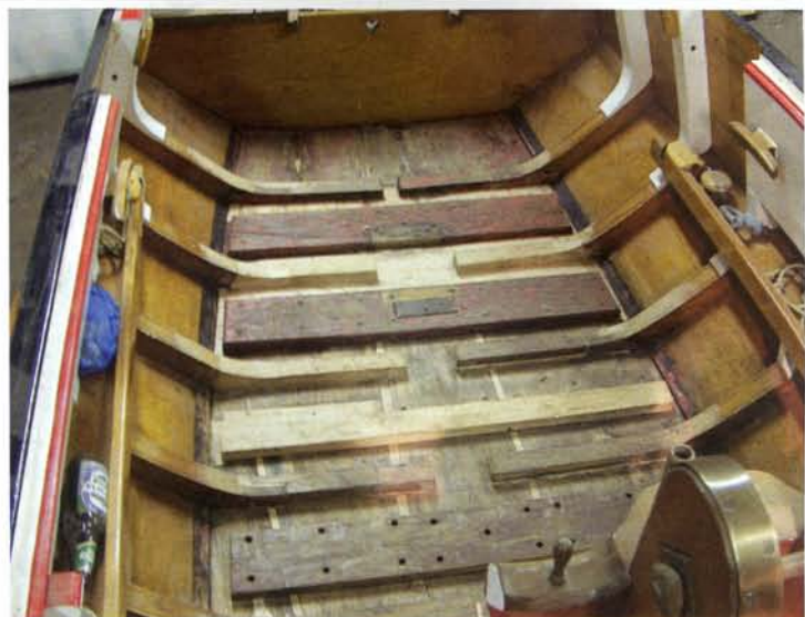
Veel spanten en kniestukken werden vernieuwd. Onder. De bedelbalk ziet er weer als nieuw uit
