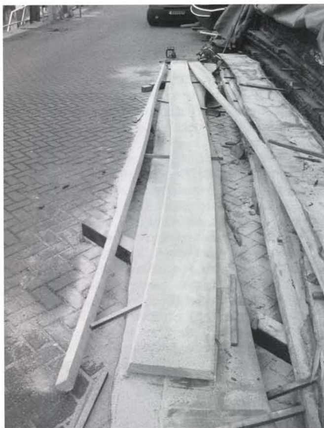
De gang is uitgezaagd volgens de mal.
