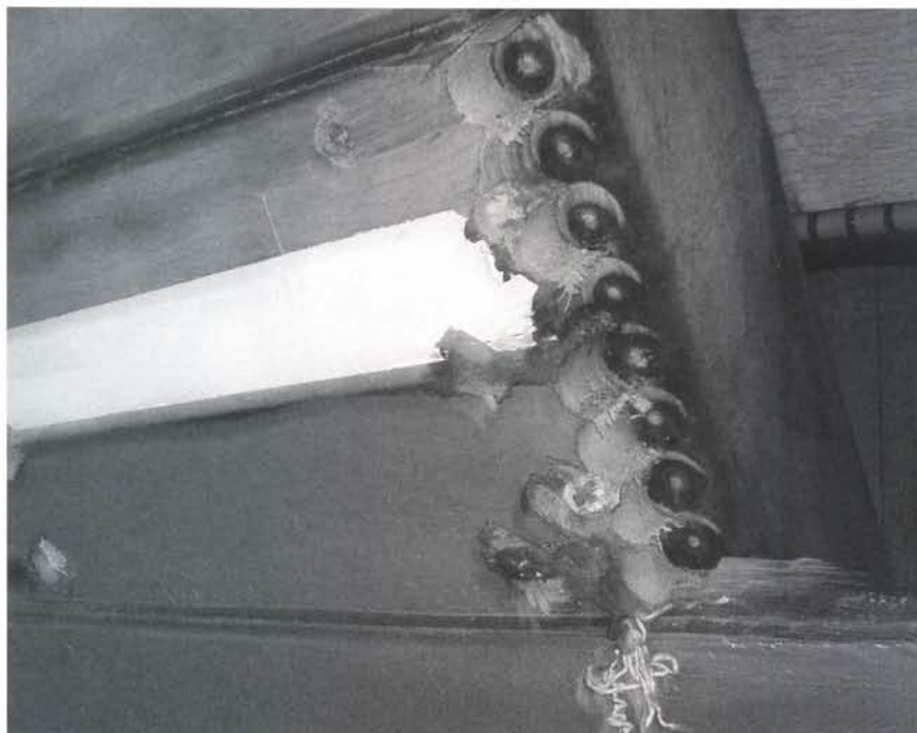
Te zien is hoe het hout rond de oude nagels wordt weg geboord, waarna de nagel eenvoudig is te trekken. Daardoor komt de gang los en kan worden verwijderd.
