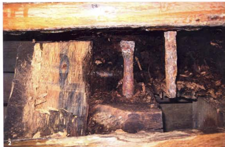
1 De "plaats delict" in het boeisel waar het allemaal mee begon • 2 Van links naar rechts: een kapotte en rotte knie, een rotte spantkop en die turf was ooit de mastdoft 3 De binnenbetimmering van de kajuit moest zo voorzichtig mogelijk van de wegering van de spanten afgetrokken. De latten kwamen goed los omdat ze gespijkerd waren en werden genummerd bij elkaar geplakt in een stapeltje, om te hergebruiken
