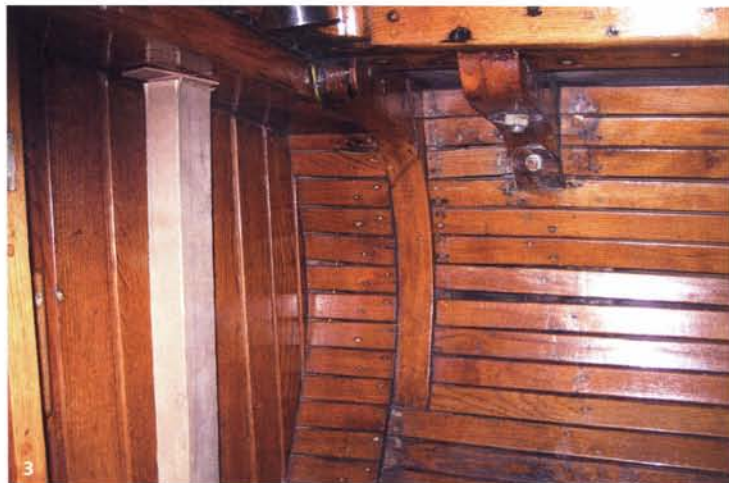
1 De "plaats delict" in het boeisel waar het allemaal mee begon • 2 Van links naar rechts: een kapotte en rotte knie, een rotte spantkop en die turf was ooit de mastdoft 3 De binnenbetimmering van de kajuit moest zo voorzichtig mogelijk van de wegering van de spanten afgetrokken. De latten kwamen goed los omdat ze gespijkerd waren en werden genummerd bij elkaar geplakt in een stapeltje, om te hergebruiken
