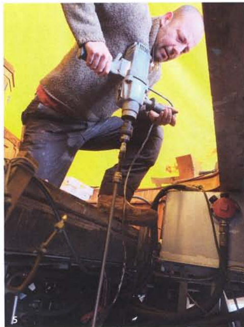
1 Nieuwe liggers worden een voor een zorgvuldig op hun plek geschoven • 2 Nadat het interieur helemaal open is komen te liggen zijn de nieuwe liggers zichtbaar 3 Ook de achterstevens en de liggers in het achterschip moesten worden vernieuwd • 4 Met een scherp oog konden de eerste gangen worden geplaatst 5 Om de loze kiel met lange draadeinden te bouten moest er flink geboord worden • 6 Voorboren om de huidgangen aan de spanten vast te zetten 7 Ook het interieur werd natuurlijk flink onder handen genomen. Dit bleek een ideale klus voor een stagiair
