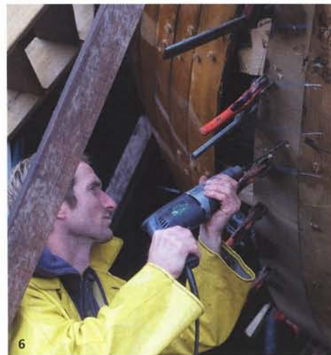
1 Nieuwe liggers worden een voor een zorgvuldig op hun plek geschoven • 2 Nadat het interieur helemaal open is komen te liggen zijn de nieuwe liggers zichtbaar 3 Ook de achterstevens en de liggers in het achterschip moesten worden vernieuwd • 4 Met een scherp oog konden de eerste gangen worden geplaatst 5 Om de loze kiel met lange draadeinden te bouten moest er flink geboord worden • 6 Voorboren om de huidgangen aan de spanten vast te zetten 7 Ook het interieur werd natuurlijk flink onder handen genomen. Dit bleek een ideale klus voor een stagiair
