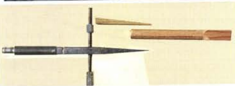
links, midden: De liggers worden stuk voor stuk aangebracht. Tijdelijk zijn ze gefixeerd met zware bouten, dan worden de gaten voor de houten pennen geboord. De pennen worden van onderen af ingeslagen. De vierkante kop wordt er later afgezaagd. Met een zelfgemaakte priem, die gemakkelijk weer
