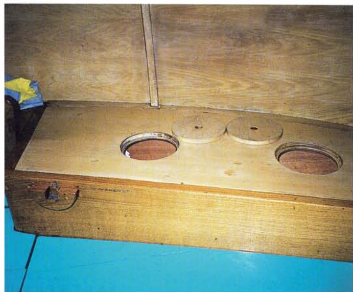
In de banken zijn mangaten gemaakt om de bergruimte te bereiken.
