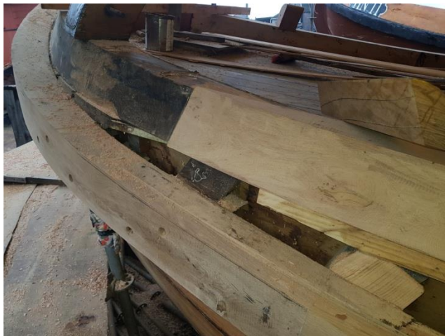
guur 5 ook het boord op de placht bb vervangen
