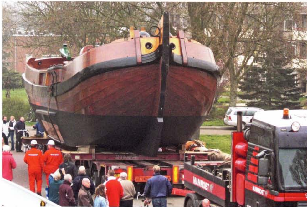
De palingaak wordt op een enorme dieplader naar de Loswal in Heeg gereden. Daar staat een 400 tons kraan van Mammoet klaar om de Korneliske Ykes II in het water te zetten en de mast te plaatsen.
