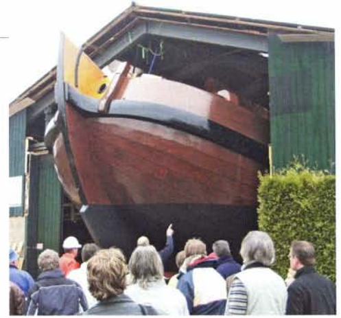
De Korneliske Ykes II wordt door de mensen van Mammoet Transport uit de bouwhal gehaald. Dit is een precisie-operatie die technisch en zeer gecompliceerd is. Eerst moet de voorgevel verwijderd worden om de hele operatie mogelijk te maken.
