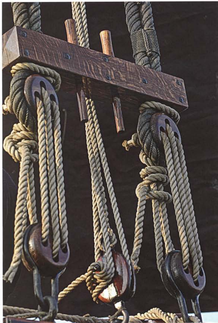
De mast was zwaar gestaagd. De talrepen met jufferblokken zorgden voor voldoende spanning op het want.
