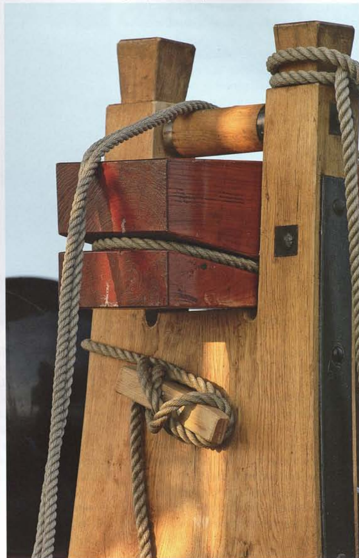
De mast was zwaar gestaagd. De talrepen met jufferblokken zorgden voor voldoende spanning op het want.
