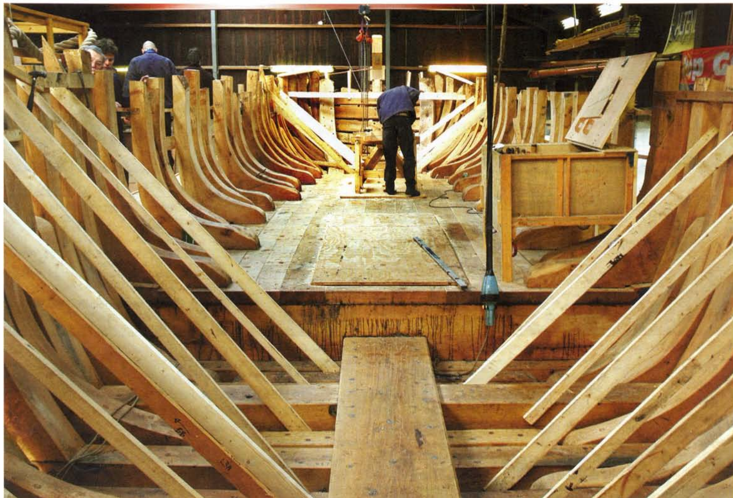
Om de opwaartse druk op de deek te weerstaan worden er zware kniën geplaatst. De bovenkant van de deek is 4 Friese duimen, oftewel 9,5 cm, dik.
