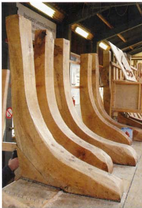
Om de opwaartse druk op de deek te weerstaan worden er zware kniën geplaatst. De bovenkant van de deek is 4 Friese duimen, oftewel 9,5 cm, dik.
