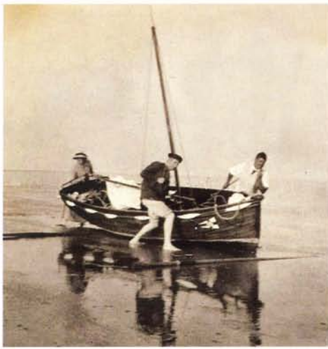
Na een bezoek aan het Griend moet de sloep een flink stuk over het droge wad worden gesleept. De riemen worden gebruikt om de sloep beter te laten glijden.
