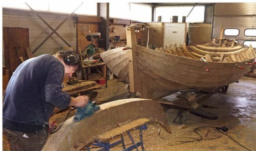
onder: Wout Rijpma is met een elektrische schaaaf bezig met het pasmaken van een zware legger. Er was heel wat krom hout nodig voor de krommers (rechts)
