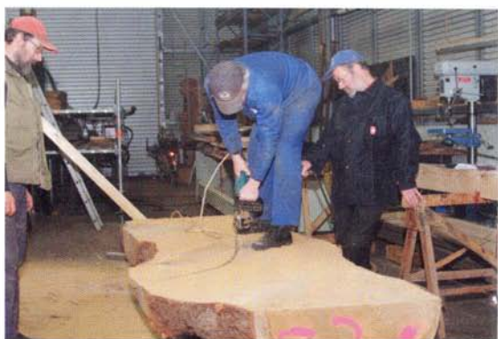
Het zagen van een spant.
