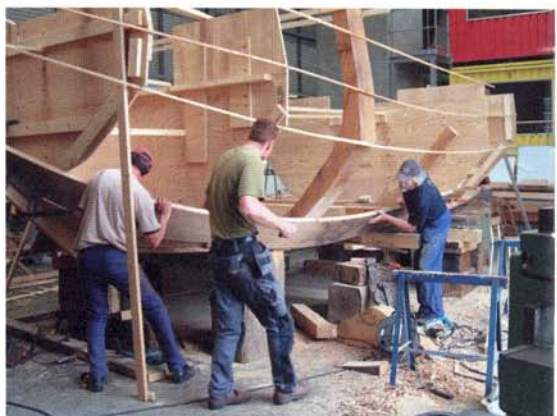
Plaatsen van een huidplank.
