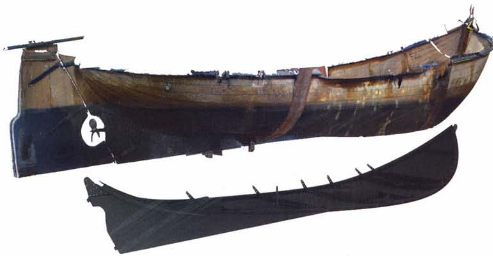
boven: De romp in 3D foto's samengesteld. Eronder het nieuw ontworpen vlak met loefbijter en scheg
