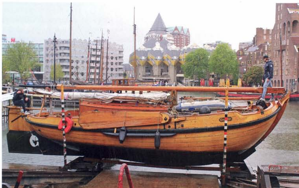
De Geertje op de dwarshelling van Koningspoort. Daar na zet de kraan haar op de wal. (Foto HJV-Koningspoort)
