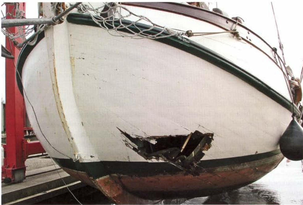
Na de onfortuinlijke aanvaring op het Snekermeer. November 2004. Het grote gat uit Sneek werd met teak hersteld, mei 2005.
