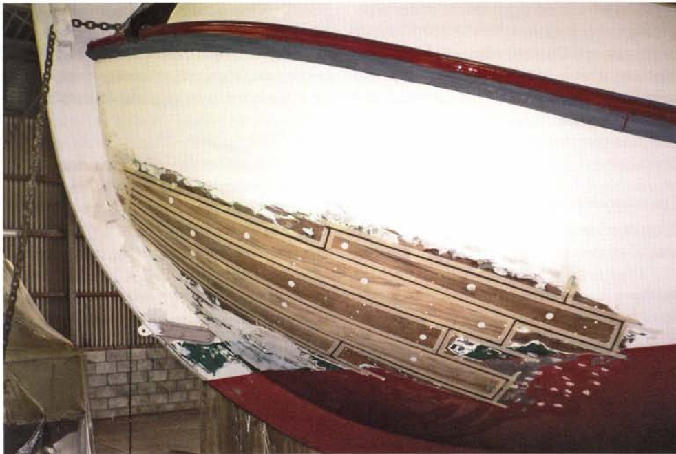
Na de onfortuinlijke aanvaring op het Snekermeer. November 2004. Het grote gat uit Sneek werd met teak hersteld, mei 2005.
