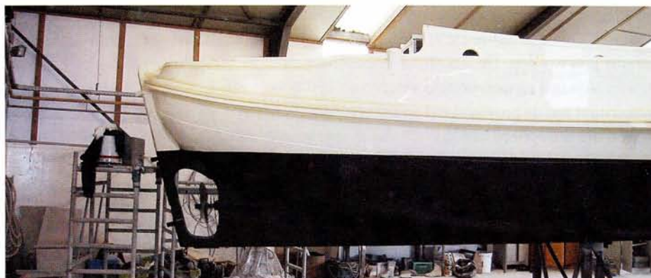
Boven: Het gerestaureerde casco staat in de primer. Onder: Het onderwatersysteem wordt aangebracht.
