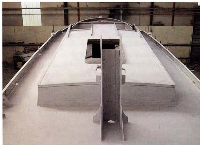
Er is een geheel stalen dek en een nieuwe mastkoker aangebracht.
