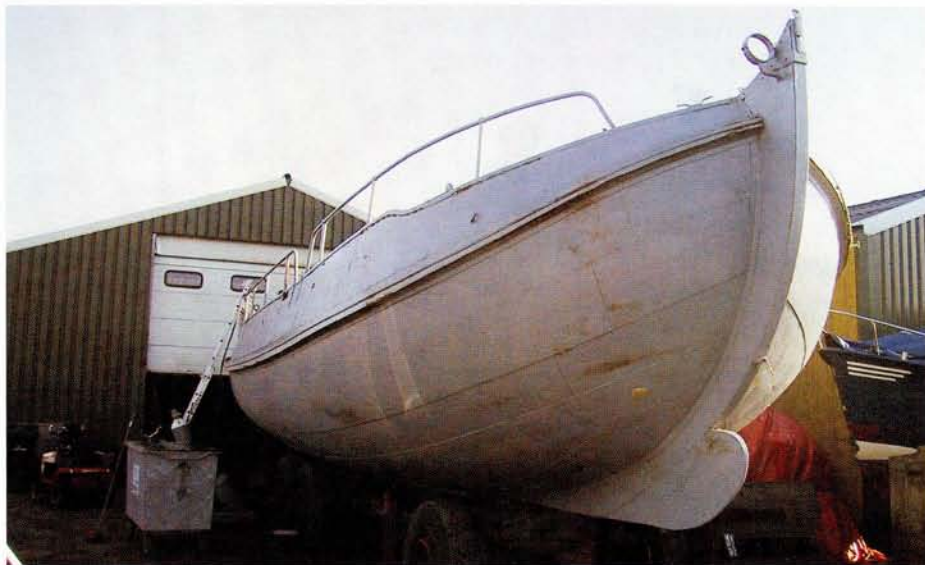
Boven: Het gerestaureerde casco staat in de primer. Onder: Het onderwatersysteem wordt aangebracht.
