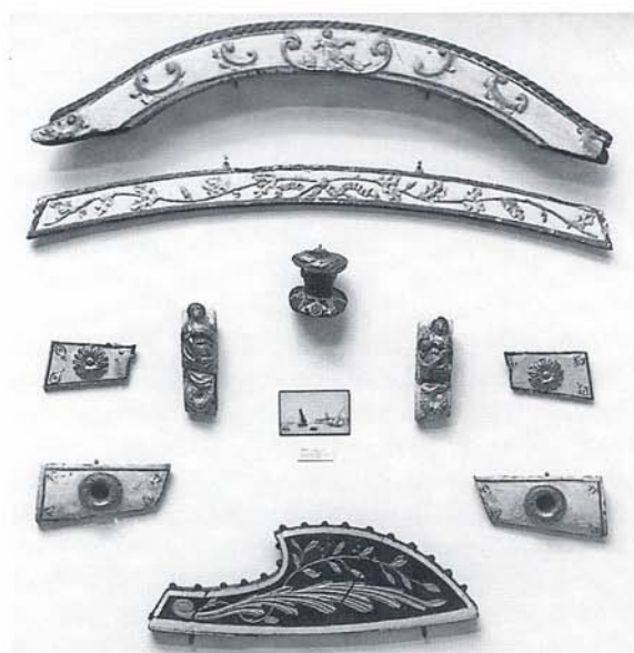
Enige bewaardgebleven onderdelen van de "Stavo": bedelbalk, hennebalk, mantsjes, kluisborden, roerkop, de morenkop op het helmhout.
