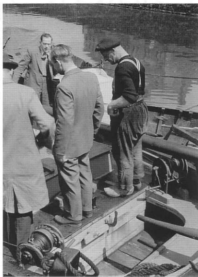
Schot kijkt in zelfverzekerdheid toe, wat de deskundigen van zijn motor vinden. Op deze foto zijn de zware lieren te zien en de koppeling van de motor.
