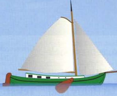
Tjalk "de Tijd zal het Leeren" 16,52 x 3,54m. (54.2 x 11.6) ijzer; gebouwd in 1912
