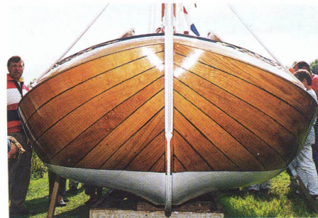
Boven: Een prachtig gepiekte spantvorm siert de Twee Gebroeders .
