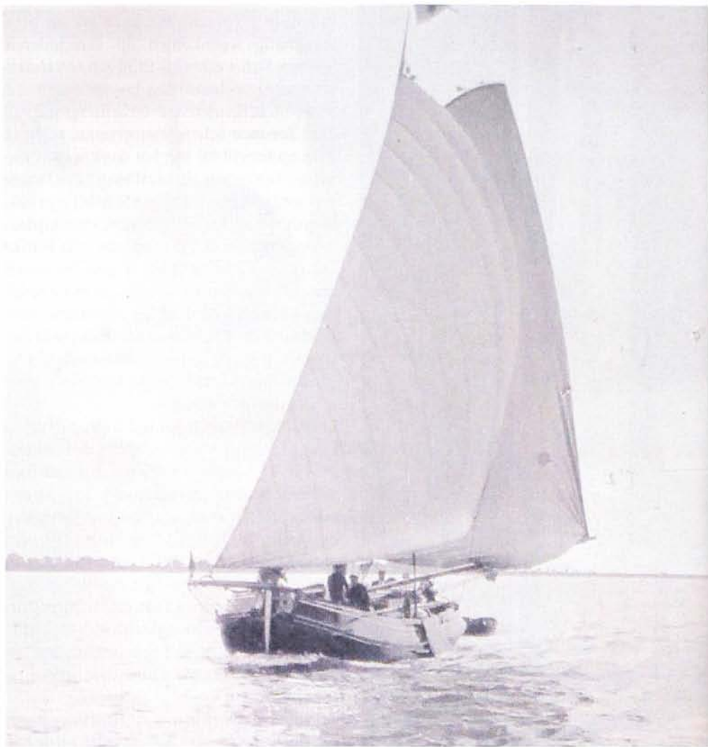
Vanaf de kluiverboom voerde de Vabel al een grote halfwinder. Typisch is dat de boeier behalve een botteloef ook een kluiverboom had
