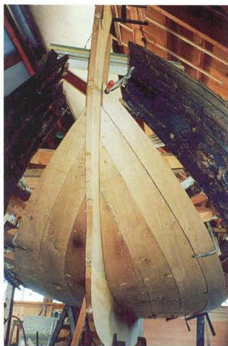
Gang voor gang werd vervangen, tot de hele huid was vernieuwd.
